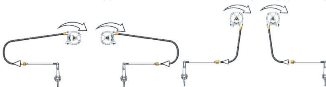
Системы тянущего и толкающего действия
